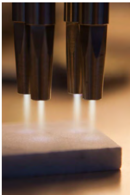
Figuur 4: Plasma cleaning en activatie van substraat
